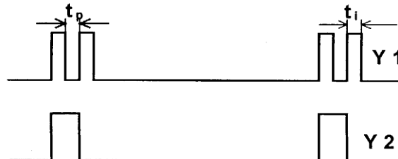
Rys. 3.4. Idealizowany przebieg napięcia generatora (Y1) i napięcia wyjściowego przerzutnika przy sterowaniu impulsami podwójnymi, gdy przerzutnik jest w stanie odróżniać impulsy.
