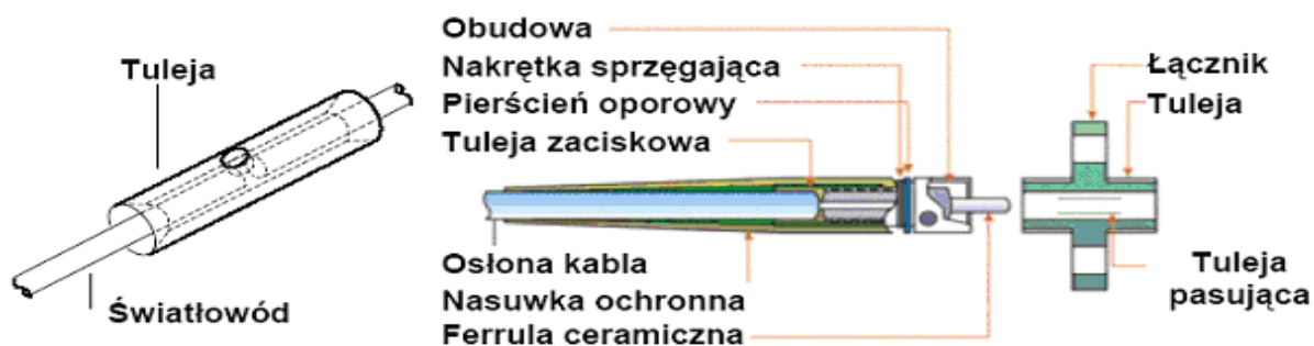
Rys.2 Budowa złączki światłowodowej
