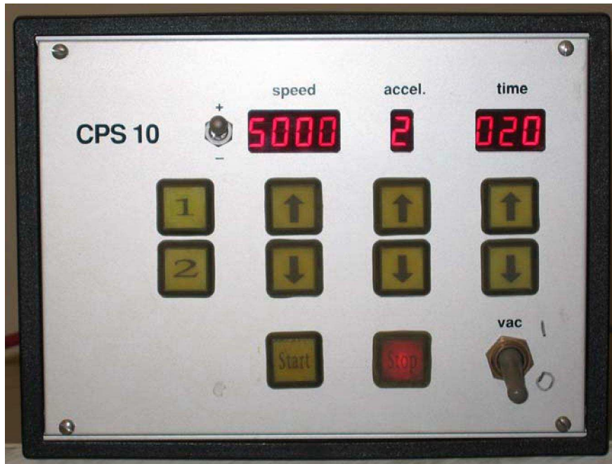
Fot. 4.1. Panel kontrolny wirówki.
