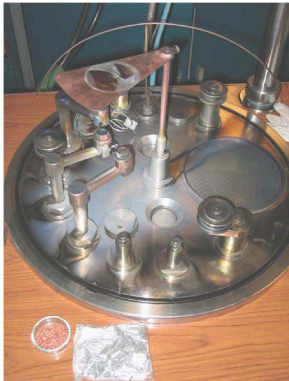
Rys. 3.6. Wnętrze reaktora napylarki.
